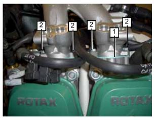
1 Isolating flange 2 Hex./Torx-flange screws M6x20
